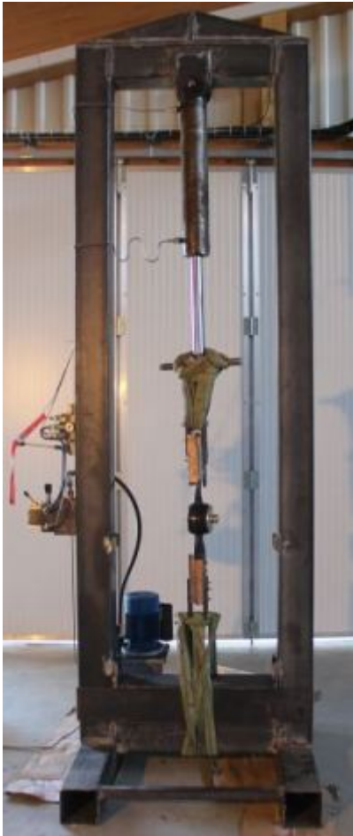
banc hydraulique d'essais de traction et montage de l'hélice sur le banc
